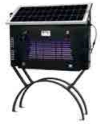
G-3 太陽能滅蚊燈 開關方式: 感光底自動開關 誘蚊方式: 紫外線誘蚊 應用面積: 300-500 平方米 尺寸: (W) 820 x (H) 669mm 電池: 2000mAh (充電時不可使用) 充電方式: 太陽能/行動電源(不可同時使用)
